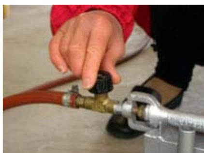
⑦バーナー側のバルブを「開く」の方向に全開し、バーナーの火口からガスを出します
