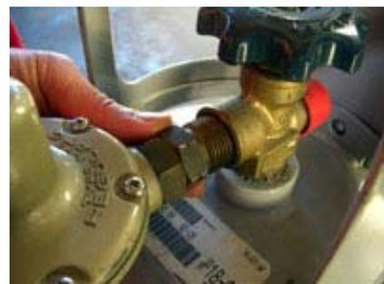
③圧力調整器をガスボンベのガス取出し口にねじ(左ねじ)を回して取り付けます
