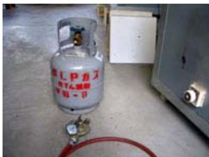
②簡易プロパンガスボンベを用意します。ガスボンベは窯から離して置きます
