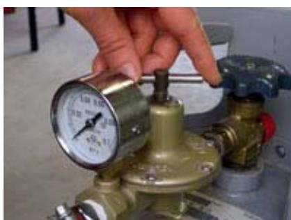
⑤圧力調整器のねじを時計回りに回して
